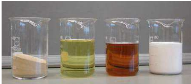
Alcune formulazioni solide e liquide di prodotti fitosanitari. Da sinistra a destra: WG, SL, EC, SC.
