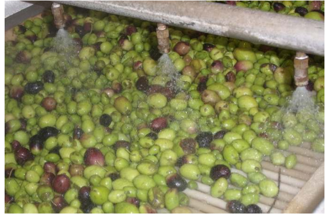
Fase di lavaggio delle olive in frantoio
