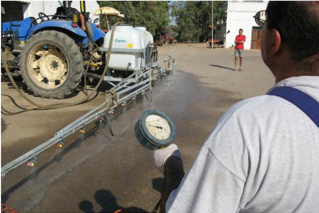
Controllo della pressione di uscita dall'ugello di fine barra
