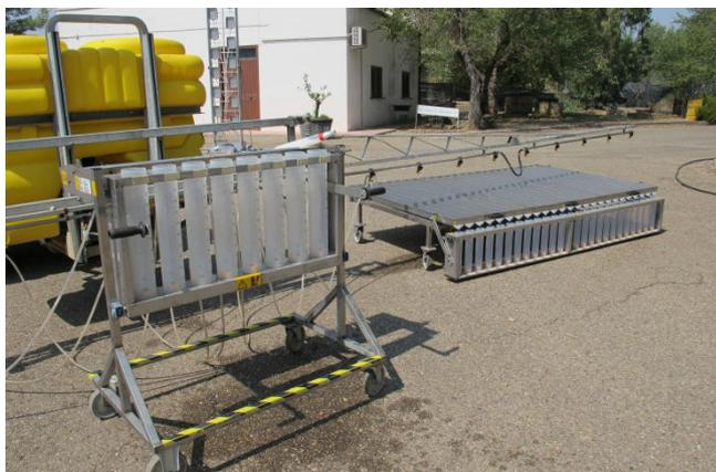
Strumentazioni per il controllo funzionale di una barra irroratrice
